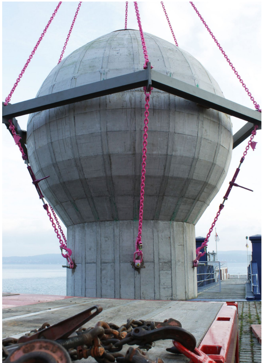
Prototyp im Test: Beton-Hohlkugel mit einem Durchmesser von 3 m.
