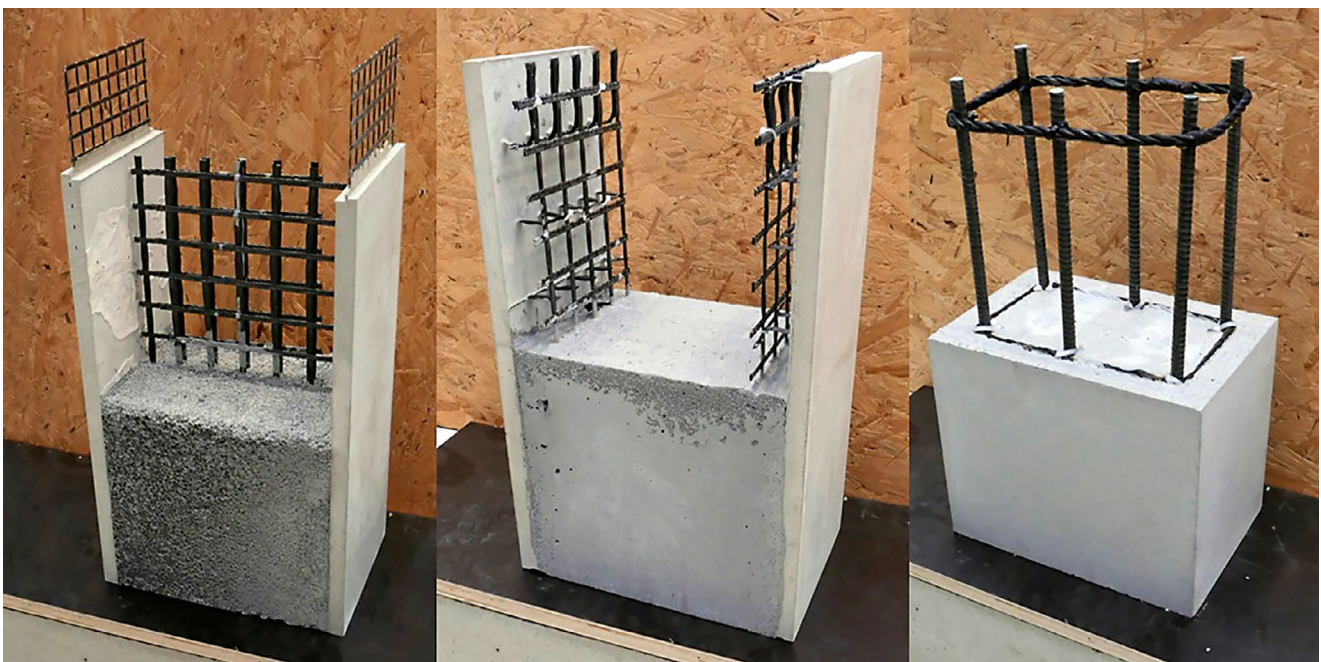
Infralichtbeton mit Textil- und Basaltbewehrung (Bauteil rechts)
