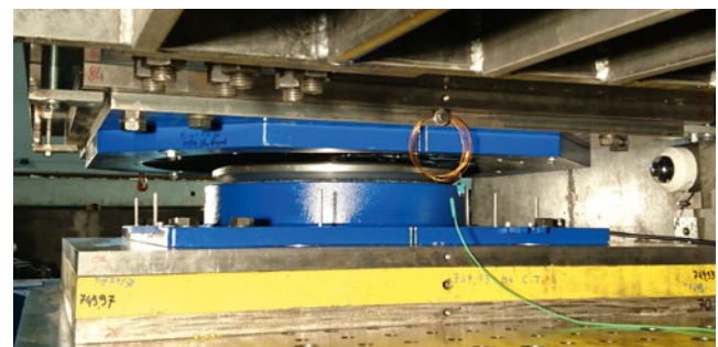
Gleitpendellager im Teststand in Pavia: Die Lager können Vertikallasten bis zu 40 MN übertragen.
