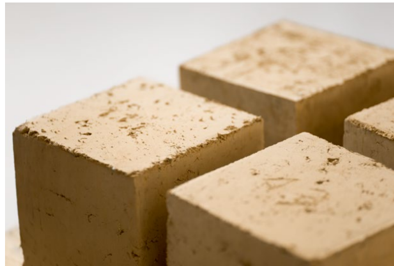
Stampflehmwürfel zur Druckfestigkeitsprüfung im ZRS-Labor
